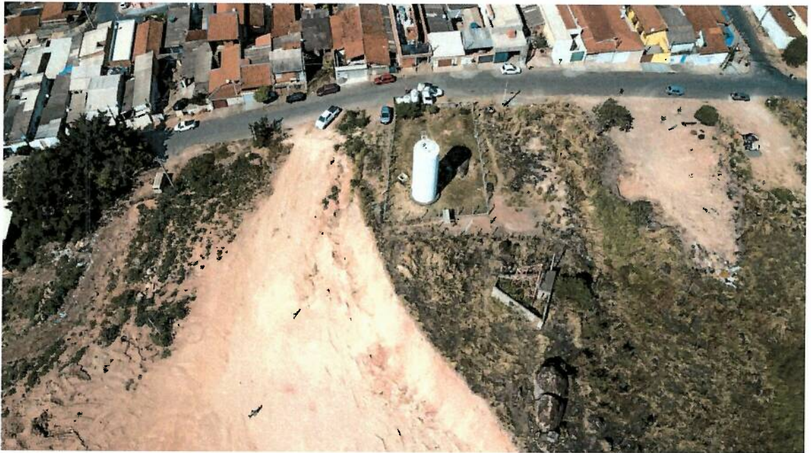
Foto 03 – Nesta foto notamos a proximidade do corte realizado, sem critério técnico, próximo ao reservatório.
